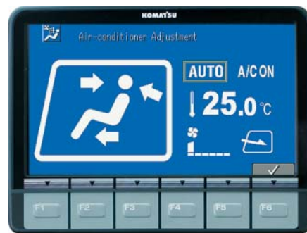
Кондиционер с автоматическим управлением
